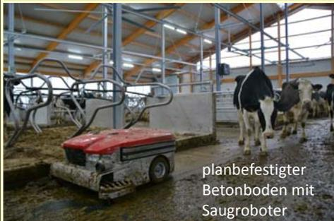
planbefestigter Betonboden mit Saugroboter
