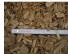
In 13 Tagen wurden 160srm von WG=45% auf WG=8% getrocknet. Dabei wurde eine Wassermasse von 21,2 Tonnen verdunstet, also **1,63 Tonne pro Tag**. Die Verdunstungsenergie von 13,4MWh entspricht etwa 1300Litern Heizöl. Bei einem Luftdurchsatz von ca. 400.000 m<sup>3</sup>/Tag ergibt sich eine Wasseraufnahme von durchschnittlich 4g/m<sup>3</sup>.
